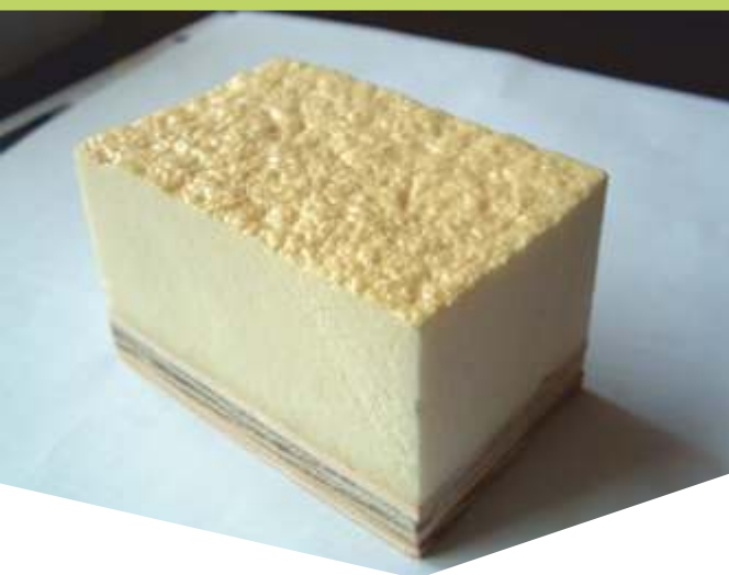
На фото: напыление вспененного пенополиуретана.
