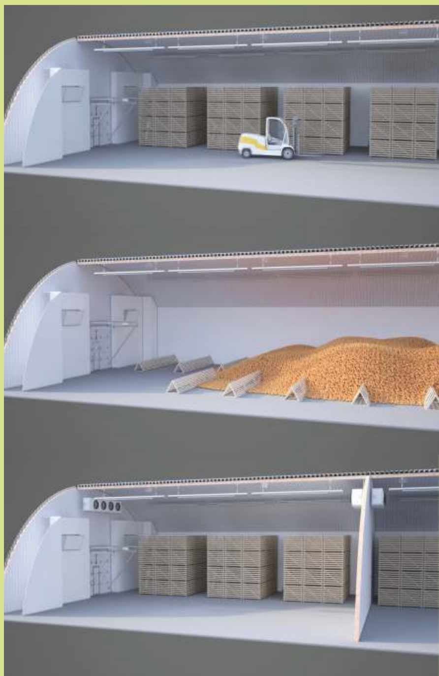
На фото (сверху вниз): П1 (к) контейнерное хранение картофеля, свеклы, капусты. П1 (б) картофелехранилище в буртах. П2 (морковехранилище, фруктохранилище).
